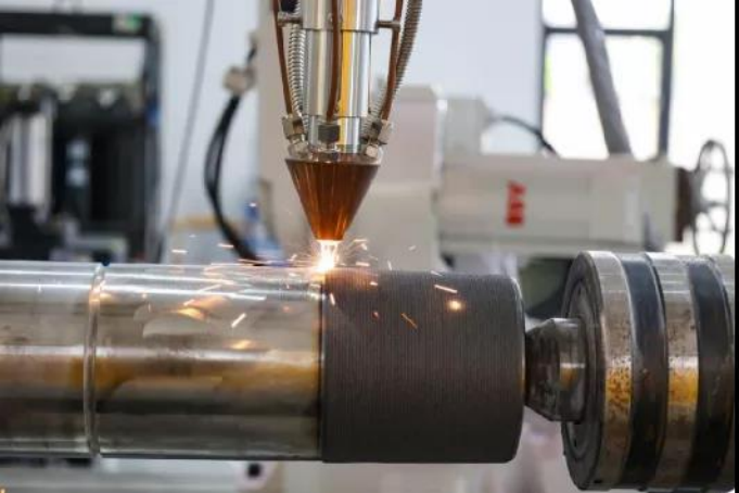
图 8：轴件激光熔覆加工效果
